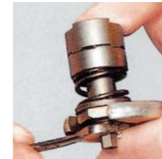
Схема регулировки момента в шуруповёртах с внутренней регулировкой
