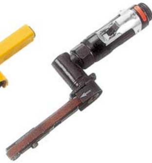
AT-7011 Ленточная шлифмашина на 16000 об./мин.
