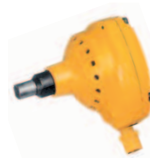
AT-3100 Гвоздезабивной пистолет 1000 ударов/мин.
